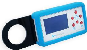
**TM-PROG RID** ist ein Programmiergerät mit dem Notleuchten der TM-CB|DATA2|DATA2 RADIO|DATA3|DATA3 RADIO|DALI|DALI-2-Systeme adressiert werden können.
