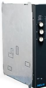
Контроллер цепей MCL-Н. Устройство для управления выходными цепями. В зависимости от режима работы включает соответствующий вид напряжения (AC или DC), управляет контрольными светильниками CBM, проводит измерения тока DC и активирует модифицированный режим светильников.
