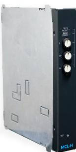
Контроллер цепей MCL-H. Устройство для управления выходными цепями. В зависимости от режима работы включает соответствующий вид напряжения (AC или DC), управляет контрольными светильниками CBM, проводит измерения тока DC и активирует модифицированный режим светильников.
